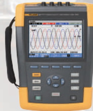
電力品質與電能量分析儀 Fluke 430 II Series : 434 II、435 II、437 II、438 II
