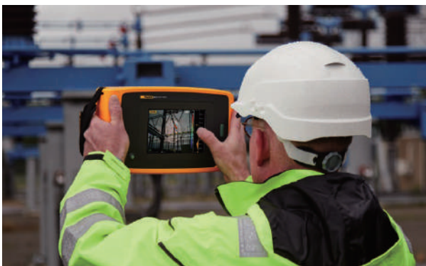
使用 Fluke ii910 拍攝影像, 可偵測高電壓應用中的局部放電。
