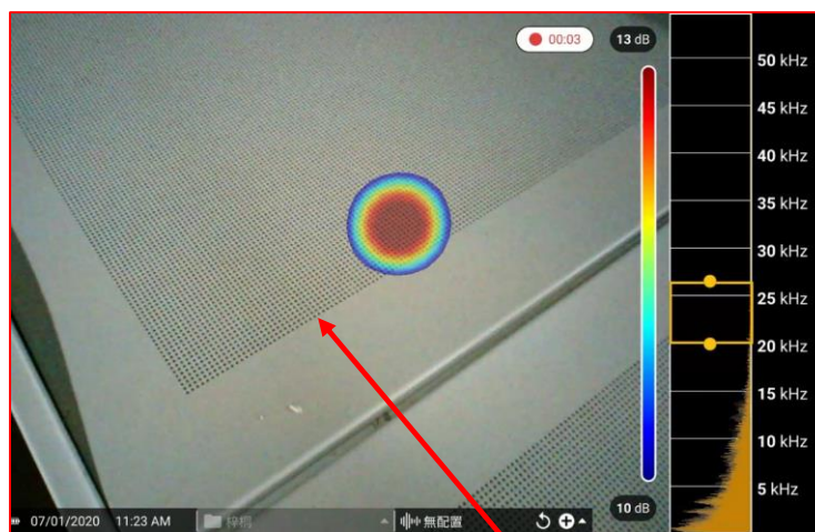
變壓器櫃頂板有散熱孔，可以進行超聲波局放排查
