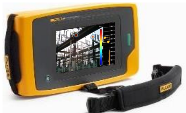
在可見光中準確定位局部放電位置
